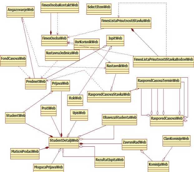
Fig. 12. POJO class diagram.
